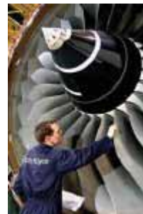
De vorm van de turbinebladen zorgt voor minder lawaai en beter aërodynamica.
